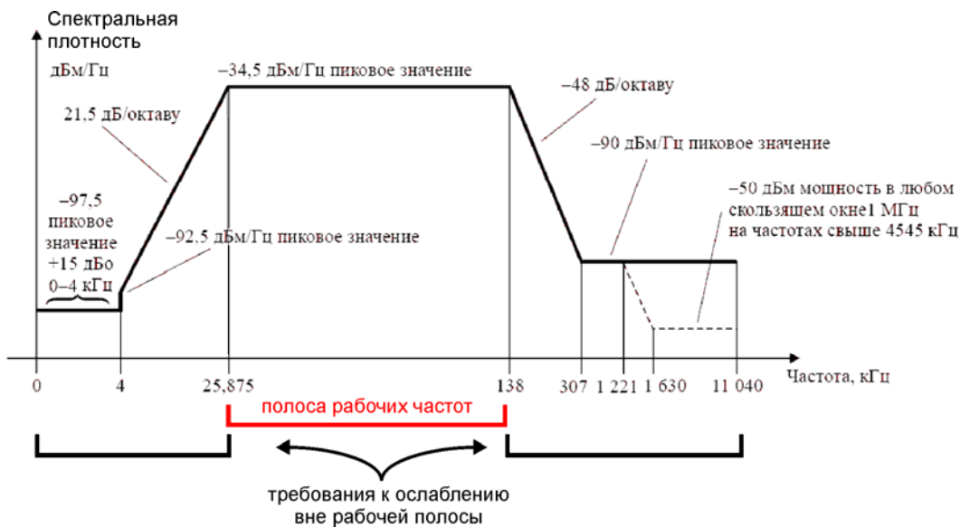
Рис. 31. Спектральная маска передатчика абонента ADSL и ADSL2.
