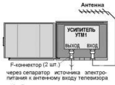
Рисунок 2 - Подключение усилителя к внешним устройствам
