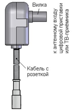
Рисунок - Общий вид и подключение усилителя
