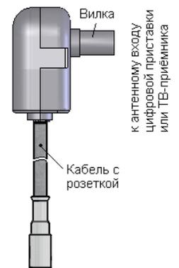
Рисунок - Общий вид и подключение усилителя
