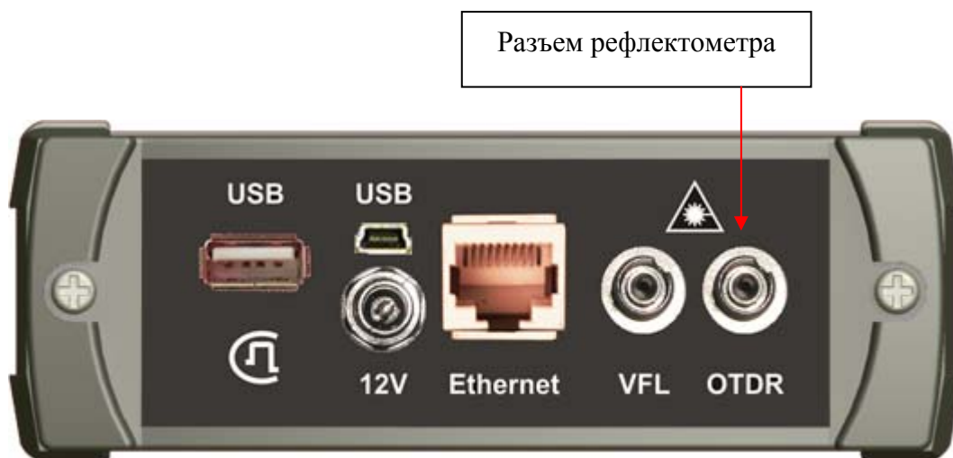
Рис. 69. Подключение оптического волокна к OTDR.
