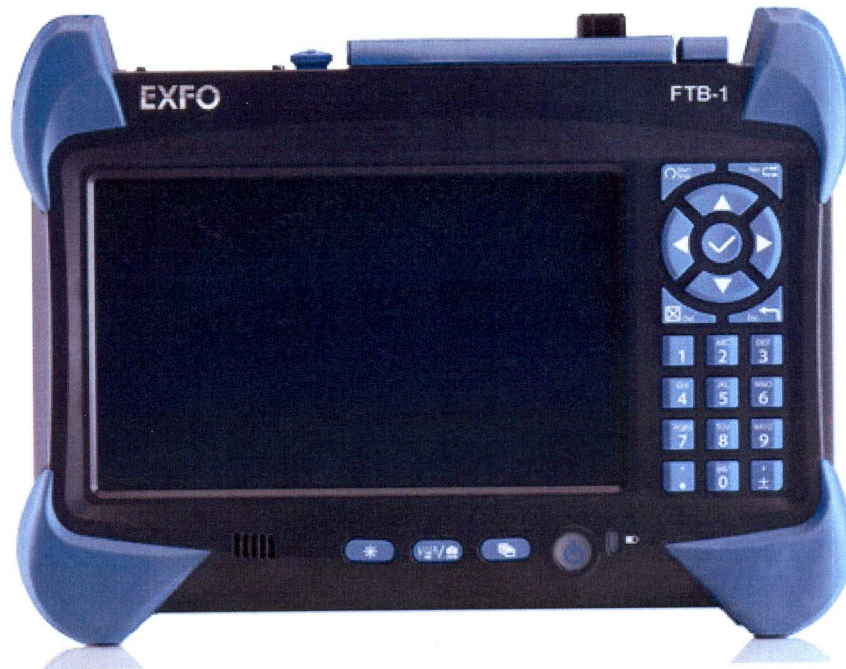
Рисунок 1 – Внешний вид системы измерительной FTB-1
